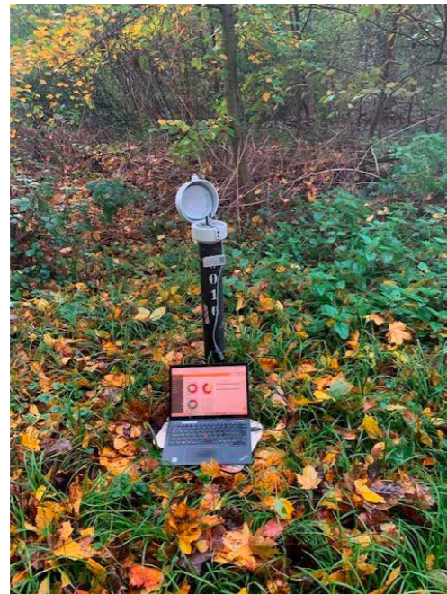
Datenübertragung an einem Grundwasserpegel im Hardwald
