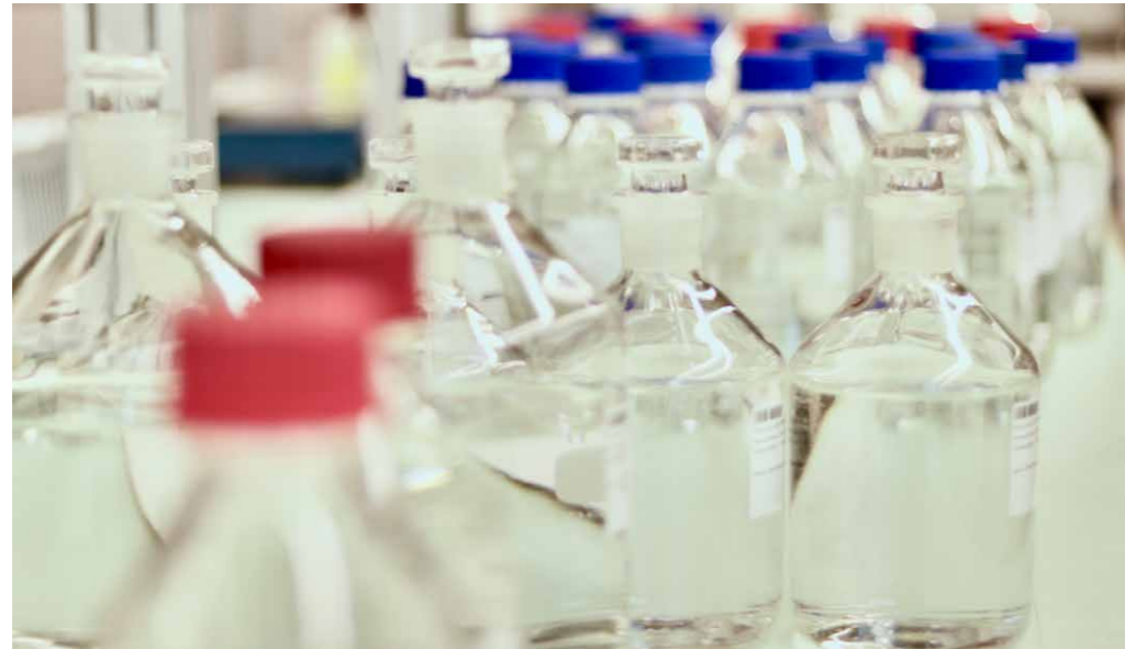
Wasserproben für die Analyse – Probenflaschen werden je nach zu messendem Parameter ausgewählt
