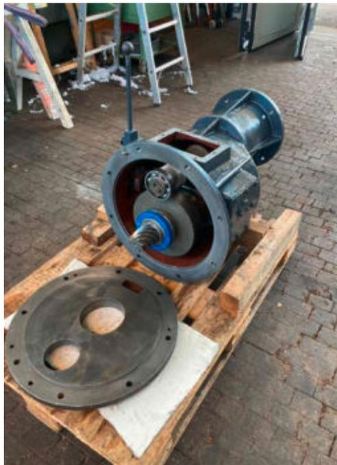
Teile des Cyclator-Rührwerkgetriebes
