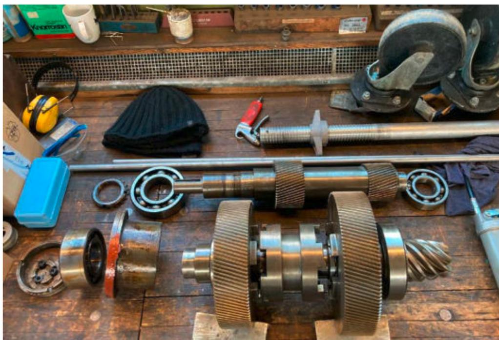
Die Zerlegung und Aufarbeitung der einzelnen Getriebeteile erfolgte in der Werkstatt der Hardwasser AG
